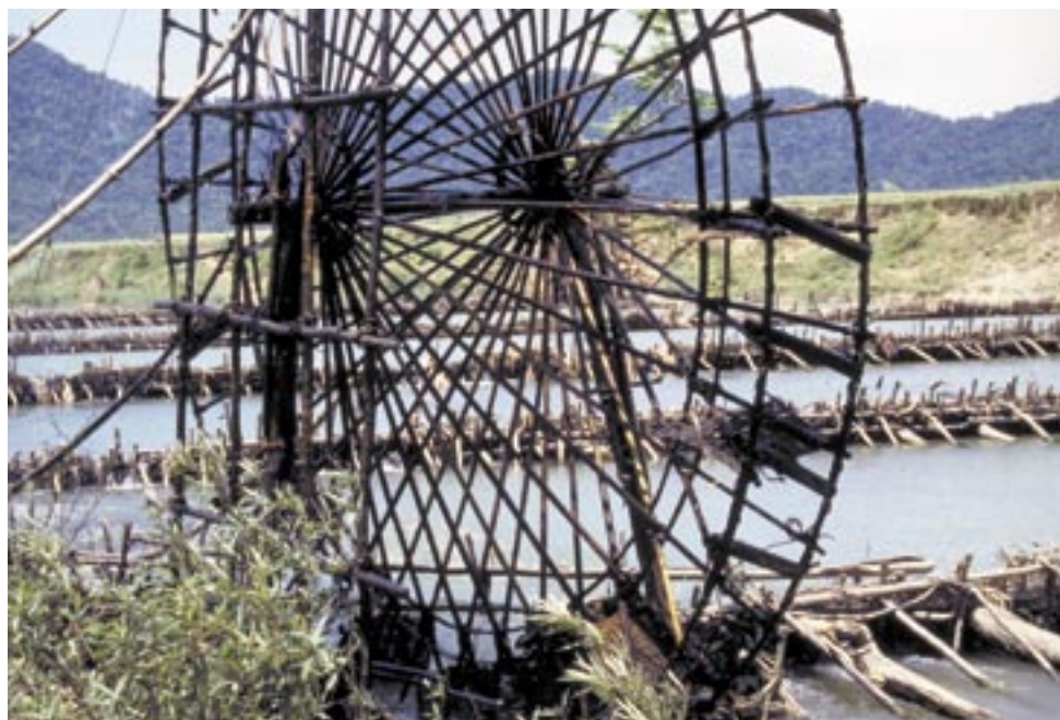
Umverteilung konkret: ein Bambuswasserrad dient im vietnamesischen Bergland zur Bewässerung der Reisfelder.
